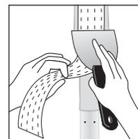
Centre una tira de cinta ToughRock sobre la junta y presiónela firmemente dentro del compuesto de apoyo húmedo con su cuchilla para panel de yeso a un ángulo de 45°. Presione con suficiente fuerza para extraer un poco de compuesto del borde de la cinta, dejando suficiente compuesto para lograr una unión adecuada. Deje secar durante aproximadamente 24 horas
