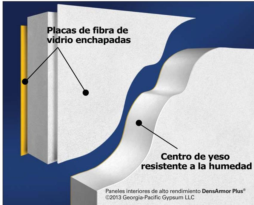
Los paneles interiores de alto rendimiento **DensArmor Plus®** poseen placas de fibra de vidrio para una mayor protección contra el moho y la humedad en comparación con placas de yeso con cubierta de papel.
